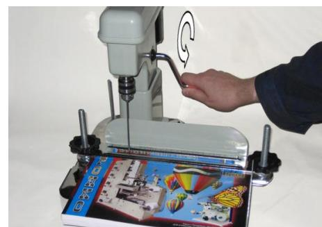
**7.** Переплет начинайте с левой стороны. Выберите место прокола, и медленно поворачивая рычаг против часовой стрелки, иглой с крючком производите сверление. При сверлении толстого материала, пройдя иглой с крючком 1,5-2,0 см, необходимо повернуть рычаг обратно, чтобы стружка вышла наверх. Так, повторяя операцию, производите сверление.
