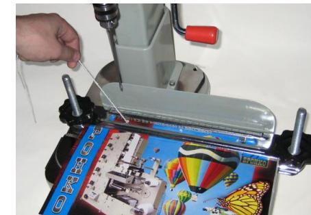
**10.** Производите сверление второго отверстия, для чего зажимное устройство двигается справа налево. После сверления второго отверстия достаете нить, и оставляете ее кольцом. Таким образом просверливайте столько отверстий, сколько вам необходимо (обычно 3 или 4).
