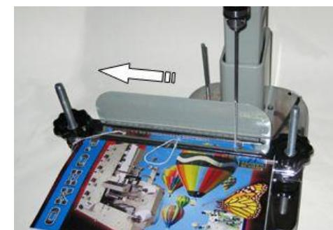
**11.** После окончания сверления последнего отверстия перерезать нить (примерно 20 см).
