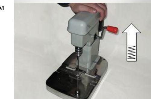
**3.** Образец нити установлен на станке. Если нет, установите нить как показано на рисунке и вытяните ее примерно на 25 см.
